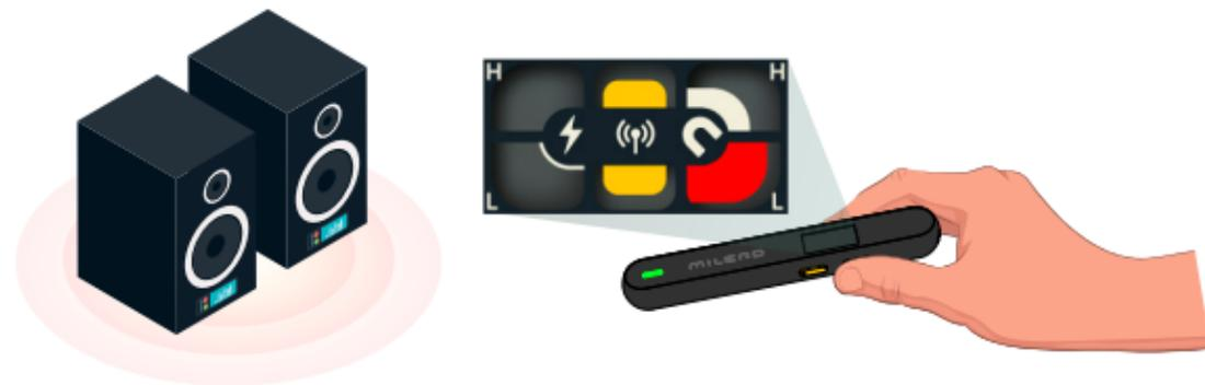
ВЫ МОЖЕТЕ ПЕРЕКЛЮЧИТЬСЯ В РЕЖИМ ПОИСКА, УДЕРЖИВАЯ ПРАВУЮ КНОПКУ НА ГЛАВНОМ ЭКРАНЕ. В ДАННОМ РЕЖИМЕ ОТОБРАЖАЮТСЯ ИЗМЕРЯЕМЫЕ ПАРАМЕТРЫ ЭЛЕКТРОМАГНИТНОГО ПОЛЯ В ГРАФИЧЕСКОМ ВИДЕ. ЧЕМ ДАЛЬШЕ ОТ ИСТОЧНИКА ИЗЛУЧЕНИЯ, ТЕМ ШКАЛА НИЖЕ, И ЧЕМ БЛИЖЕ К ИСТОЧНИКУ, ТЕМ ОНА ВЫШЕ. ЦВЕТ ШКАЛЫ ИНФОРМИРУЕТ ОБ УРОВНЕ ОПАСНОСТИ КОНКРЕТНОГО ПАРАМЕТРА ПОЛЯ.
